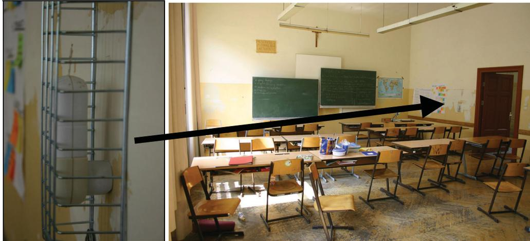
**Abb. G-1:** Temperatur- und Feuchte-Sensor im Klassenraum
